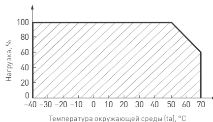
Рис. 2. Максимальная допустимая нагрузка, % от мощности источника
