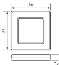
Рамка серии OMALI изготовлена из закаленного стекла высокой прочности. Корпус золотого цвета, поверхность с Soft-Touch покрытием высотой 7 мм, что позволяет гармонично встроить в интерьер любого современного дизайн-проекта. Невидимая часть из тугоплавкого пластика для надежной фиксации механизма. Предназначена под встраиваемые механизмы. Рамка стеклянная на 1 пост, под встраиваемый механизм. Среднего уровня герметичности IP20. Ориентация монтажа — горизонтальная.
