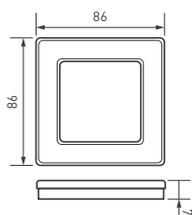
Рамка серии OMALI изготовлена из закаленного стекла высокой прочности. Корпус серого цвета, поверхность с Soft-Touch покрытием высотой 7 мм, что позволяет гармонично встроить в интерьер любого современного дизайн-проекта. Невидимая часть из тугоплавкого пластика для надежной фиксации механизма. Предназначена под встраиваемые механизмы. Рамка стеклянная на 1 пост, под встраиваемый механизм. Среднего уровня герметичности IP20. Ориентация монтажа — горизонтальная.
