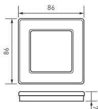
Рамка серии OMALI изготовлена из закаленного стекла высокой прочности. Корпус белого цвета, поверхность с Soft-Touch покрытием высотой 7 мм, что позволяет гармонично встроить в интерьер любого современного дизайн-проекта. Невидимая часть из тугоплавкого пластика для надежной фиксации механизма. Предназначена под встраиваемые механизмы. Рамка стеклянная на 1 пост, под встраиваемый механизм. Среднего уровня герметичности IP20. Ориентация монтажа — горизонтальная.
