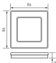
Рамка серии OMALI изготовлена из закаленного стекла высокой прочности. Корпус выполнен в белом цвете, глянцевая поверхность высотой 7 мм, что позволяет гармонично встроить в интерьер любого современного дизайн-проекта. Невидимая часть из тугоплавкого пластика, для надежной фиксации механизма. Предназначена под встраиваемые механизмы. Рамка стеклянная на 1 пост, под встраиваемый механизм. Цвет — серый. Среднего уровня герметичности IP20. Ориентация монтажа — горизонтальная.
