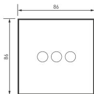
Выключатель света из серии OMALI оснащен тремя сенсорными клавишами для управления. Благодаря функции беспроводного управления по протоколу Zigbee, вы можете управлять всеми доступными функциями из любой точки. Стеклопанель глянцевая панель позволяет гармонично встроить в интерьер любого современного дизайн-проекта. Контактная часть присоединяется при помощи винтовых зажимов, а усиленная алюминиевая рамка надежно фиксирует механизм в установочном подрозетнике.
