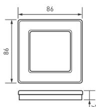
Рамка серии OMALI изготовлена из закаленного стекла высокой прочности. Корпус выполнен в белом цвете, глянцевая поверхность высотой 7 мм, что позволяет гармонично встроить в интерьер любого современного дизайн-проекта. Невидимая часть из тугоплавкого пластика, для надежной фиксации механизма. Предназначена под встраиваемые механизмы. Рамка стеклянная на 1 пост, под встраиваемый механизм. Цвет — черный. Среднего уровня герметичности IP20. Ориентация монтажа — горизонтальная.
