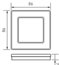
Рамка серии OMALI изготовлена из закаленного стекла высокой прочности. Корпус черного цвета, поверхность с Soft-Touch покрытием высотой 7 мм, что позволяет гармонично встроить в интерьер любого современного дизайн-проекта. Невидимая часть из тугоплавкого пластика для надежной фиксации механизма. Предназначена под встраиваемые механизмы. Рамка стеклянная на 1 пост, под встраиваемый механизм. Среднего уровня герметичности IP20. Ориентация монтажа — горизонтальная.
