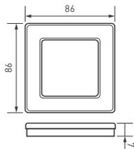
Рамка серии OMALI изготовлена из закаленного стекла высокой прочности. Корпус выполнен в белом цвете, глянцевая поверхность высотой 7 мм, что позволяет гармонично встроить в интерьер любого современного дизайн-проекта. Невидимая часть из тугоплавкого пластика, для надежной фиксации механизма. Предназначена под встраиваемые механизмы. Рамка стеклянная на 1 пост, под встраиваемый механизм. Цвет — белый. Среднего уровня герметичности IP20. Ориентация монтажа — горизонтальная.
