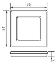
Рамка серии OMALI изготовлена из закаленного стекла высокой прочности. Корпус выполнен в белом цвете, глянцевая поверхность высотой 7 мм, что позволяет гармонично встроить в интерьер любого современного дизайн-проекта. Невидимая часть из тугоплавкого пластика, для надежной фиксации механизма. Предназначена под встраиваемые механизмы. Рамка стеклянная на 1 пост, под встраиваемый механизм. Цвет — золотой. Среднего уровня герметичности IP20. Ориентация монтажа — горизонтальная.
