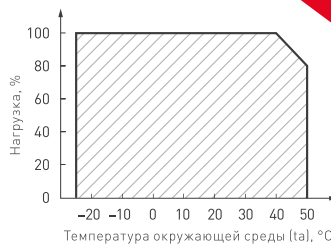
Рисунок 6. Максимальная допустимая нагрузка, % от мощности источника
