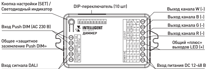
Рис. 2. Назначение элементов подключения и управления
