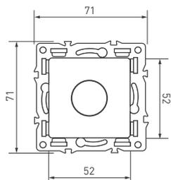
Механизм регулировки света совместим с рамками серий OMALI/AKYRI/PERIO/XSILO. Механизм позволяет регулировать степень интенсивности свечения, а также включать/выключать подключенное освещение. Скрытый тип монтажа позволяет гармонично встроить в интерьер любого современного дизайн-проекта. Видимая часть механизма выполнена из высококачественного пластика.
