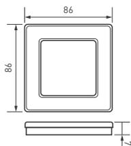
Рамка серии OMALI изготовлена из закаленного стекла высокой прочности. Корпус выполнен в белом цвете и глянцевой поверхностью с высотой 7 мм, что позволяет гармонично встроить в интерьер любого современного дизайн-проекта. Невидимая часть из тугоплавкого пластика для надежной фиксации механизма. Предназначена под встраиваемые механизмы. Рамка стеклянная на 1 пост, под встраиваемый механизм. Цвет — белый. Среднего уровня герметичности IP20. Ориентация монтажа — горизонтальная.
