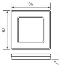
Рамка серии PERIO изготовлена из высококачественного пластика. Корпус выполнен в золотом цвете и матовым покрытием с высотой 7 мм, что позволяет гармонично встроить в интерьер любого современного дизайн-проекта. Предназначена под встраиваемые механизмы. Рамка пластиковая на 1 пост. Цвет — золотой. Среднего уровня герметичности IP20. Ориентация монтажа — горизонтальная.
