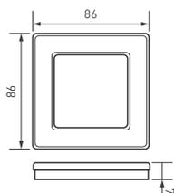
Рамка серии OMALI изготовлена из закаленного стекла высокой прочности. Корпус выполнен в сером цвете и глянцевой поверхностью с высотой 7 мм, что позволяет гармонично встроить в интерьер любого современного дизайн-проекта. Невидимая часть из тугоплавкого пластика для надежной фиксации механизма. Предназначена под встраиваемые механизмы. Рамка стеклянная на 1 пост, под встраиваемый механизм. Цвет — серый. Среднего уровня герметичности IP20. Ориентация монтажа — горизонтальная.
