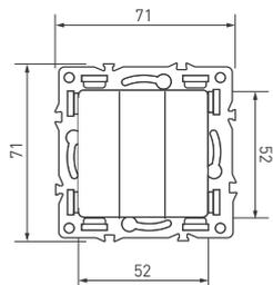
Механизм выключателя света клавишный совместим с рамками серий OMALI/AKYRI/PERIO/XSILO. Скрытый тип монтажа позволяет гармонично встроить в интерьер любого современного дизайн-проекта. Видимая часть механизма выполнена из высококачественного пластика. Контактная часть присоединяется при помощи винтовых зажимов, а усиленные монтажные лапки надежно фиксируют механизм в установочном подрозетнике.
