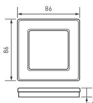
Рамка серии OMALI изготовлена из закаленного стекла высокой прочности. Корпус выполнен в черном цвете и глянцевой поверхностью с высотой 7 мм, что позволяет гармонично встроить в интерьер любого современного дизайн-проекта. Невидимая часть из тугоплавкого пластика для надежной фиксации механизма. Предназначена под встраиваемые механизмы. Рамка стеклянная на 1 пост, под встраиваемый механизм. Цвет — черный. Среднего уровня герметичности IP20. Ориентация монтажа — горизонтальная.
