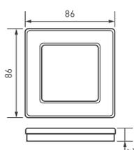
Рамка серии OMALI изготовлена из закаленного стекла высокой прочности. Корпус выполнен в золотом цвете и глянцевой поверхностью с высотой 7 мм, что позволяет гармонично встроить в интерьер любого современного дизайн-проекта. Невидимая часть из тугоплавкого пластика для надежной фиксации механизма. Предназначена под встраиваемые механизмы. Рамка стеклянная на 1 пост, под встраиваемый механизм. Цвет — золотой. Среднего уровня герметичности IP20. Ориентация монтажа — горизонтальная.
