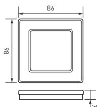
Рамка серии PERIO изготовлена из высококачественного пластика. Корпус выполнен в сером цвете и матовым покрытием с высотой 7 мм, что позволяет гармонично встроить в интерьер любого современного дизайн-проекта. Предназначена под встраиваемые механизмы. Рамка пластиковая на 1 пост. Цвет — серый. Среднего уровня герметичности IP20. Ориентация монтажа — горизонтальная.
